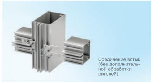
Для конструкций, где не требуется высокая жесткость, система ALT F50 предлагает возможность использования профилей ригеля в качестве вертикальных несущих стоек.
